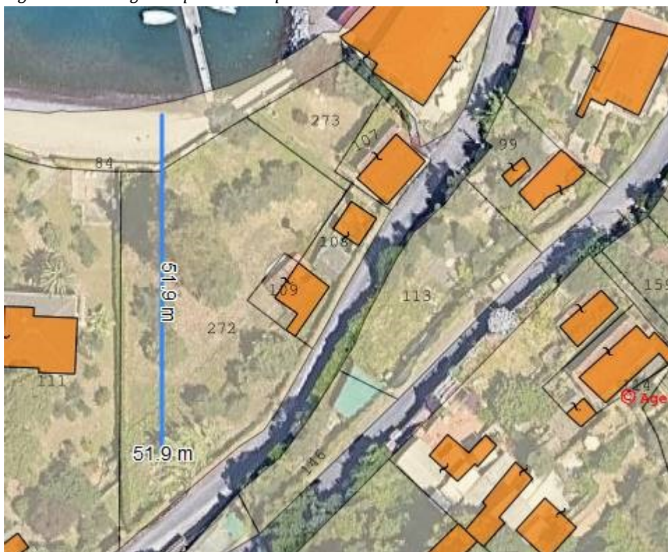
Figura 23 Distanza della condotta disperdente dalla linea di costa
